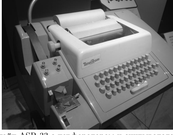
Рис. 1.4. Телетайп ASR-33 с перфоратором и считывателем перфолент 14
